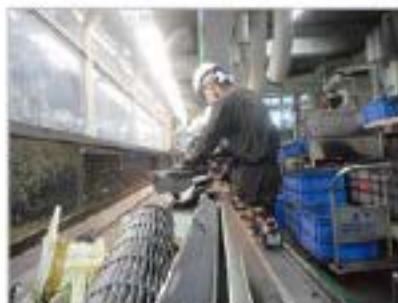
室内组件拆解流水线
