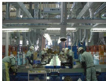
・第二工場での ブラウン管テレビの解体
